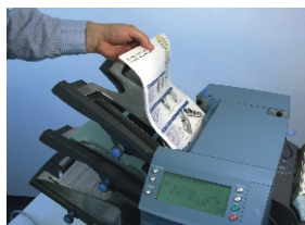
Funkcja manualna umożliwia ręczne pakowanie do 5 kartek na raz.
