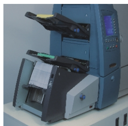
Automatyczny podajnik kopert z "widną transportującą" o powiększonej pojemności
